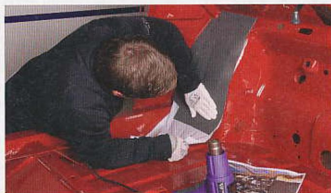
Ja, diese Arbeit hat etwas Meditatives: Wer die Dämmmatten nicht mit Ruhe und Geduld einklebt, wird irgendwann womöglich Probleme bekommen. Werden die Materialien nicht flächig angepresst, sondern...
