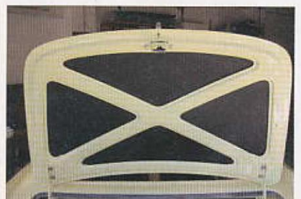
Der selbstklebende schwarze Dämmfilz im Einsatz (Volvo 1800): Das Haubenverstärkungskreuz bleibt hier frei
