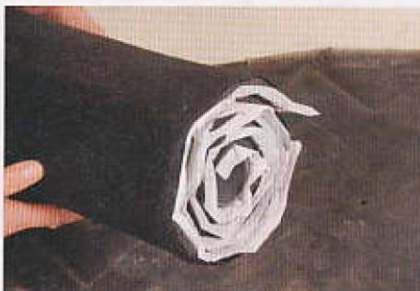
Möglichkeit vier: schwarzer Dämmfilz mit Kleberücken. Er wird direkt auf dem Haubenblech fixiert
