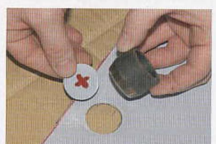
...dient dem Messer als Führung für einen geraden Schnitt. Löcher werden mit dem Stanzeisen ins Material geschlagen
