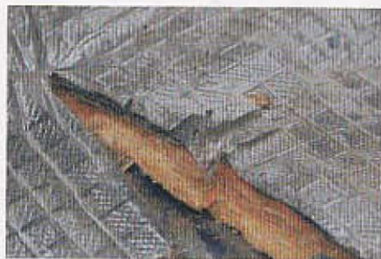
Wenn möglich, Reste als Muster aufbewahren. Hier ist gut zu sehen, dass es sich um eine Mehrschicht-Matte aus Jutefilz mit...
