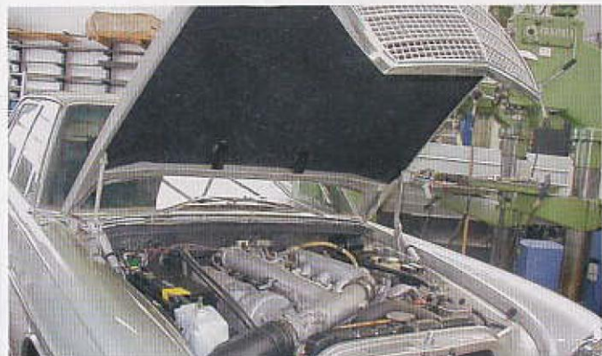
...der Motor. Das Material mit diesen Werten ist folgerichtig auch eine filzbeschichtete Motorhaubenmatte. Das gewaltige 6,3-Liter-Aggregat des Mercedes W 108 wird hiermit im Fahrbetrieb geräuschkultiviert
