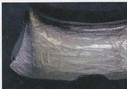
Nicht nur Schall, sondern auch Hitze kann mit vielen Materialien gedämmt werden – so wie hier am Käfer-Heckblech mit Alumatten
