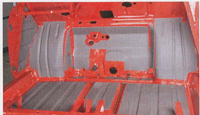
...nur schnell dahingepappt, kann sich auch beim besten Produkt der Kleber nach einiger Zeit wieder lösen. Bis der Saab originalgetreu isoliert war, ist ein Tag ins Land gezogen – keine verlorene Zeit!
