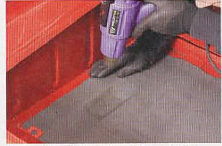
Jetzt wird's heiß: Mit dem Föhn wird die Matte erhitzt und dabei sorgfältig in die Blechsicken gedrückt – Geduld ist gefragt
