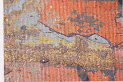
...denn oft ist er aus Kostengründen direkt aufs grundierte oder gar blanke Blech aufgebracht. Bei diesem NSU knistert's bereits gewaltig
