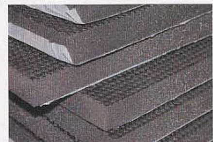
...Entdröhnung gedacht. Zur Schallabsorption von externen Lärmquellen wie dem Motor eignet sich offenzelliger Schaumstoff (o.)
