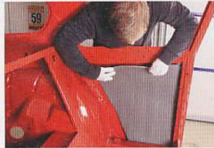
...droht sonst Korrosion. Auch auf den senkrechten Blechpartien wird die Antidröhnmatte verklebt
