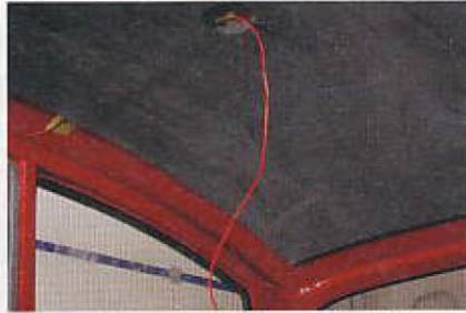
„Besser als neu“: Statt des ursprünglichen Baumwollfilz kann man moderne Ersatzstoffe nehmen – hinterher sieht's keiner mehr...
