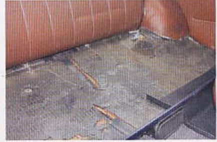
Mach mal leiser: Ein Mischmaterial sorgt beim Fiat dafür, dass der Krawall sich stets in erträglichen Dezibelbereichen bewegt
