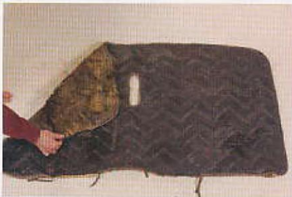
Wenn das Original nicht mehr zu retten ist: Diese ruinierte Knöpf-Dämmmatte eines Fiat 125 lässt sich auf diverse Arten ersetzen
