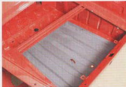
Sitzt, passt – und hat keine Luft: Die richtig installierte Dämmung liegt vollständig am Blech an. In ungewollten Hohlräumen...
