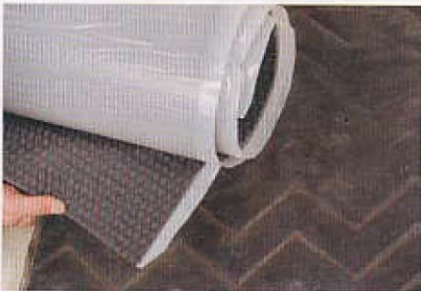
Möglichkeit drei: offenzelliger Schaumstoff. Er wird aufs Blech geklebt, die Optik ist akzeptabel, die Dämmung sehr umfangreich
