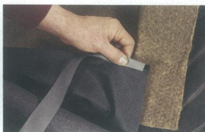
Auch aufwendige Konstruktionen lassen sich nachfertigen. In diesem Fall die bröselige Motorhauben-Dämmung eines Fiat 125, die mit Jutefilz und Innenhimmel-Kunstleder rekonstruiert wird. Für den Filz dient das Altteil als Schnittmuster (l.); mit dem Kunstleder wird er umnäht und originalgetreu abgesteppt
