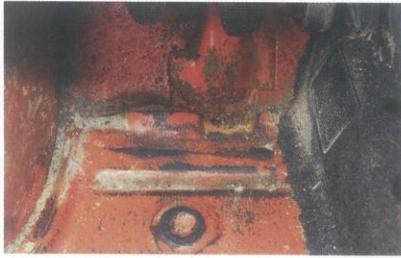
Bodendämmung geschieht in der Regel aus Temperaturgründen, der Fahrtwind kühlt das Bodenblech. Doch mit der Zeit wird die Isolierschicht oft zur Rostfalle: das Bitumen versprödet, Wasser dringt ein und sorgt für lange unentdeckte Korrosion (M.). Auch Schaumstoff (r.) altert und saugt Wasser wie ein Schwamm auf
