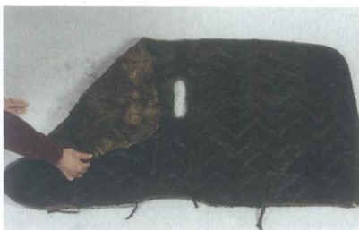
Auch aufwendige Konstruktionen lassen sich nachfertigen. In diesem Fall die bröselige Motorhauben-Dämmung eines Fiat 125, die mit Jutefilz und Innenhimmel-Kunstleder rekonstruiert wird. Für den Filz dient das Altteil als Schnittmuster (l.); mit dem Kunstleder wird er umnäht und originalgetreu abgesteppt
