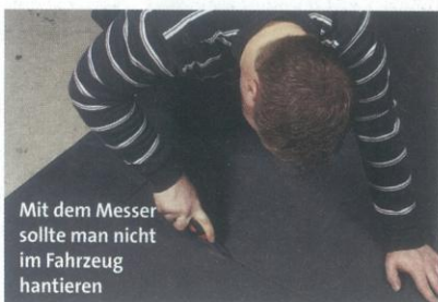
Auch aufwendige Konstruktionen lassen sich nachfertigen. In diesem Fall die bröselige Motorhauben-Dämmung eines Fiat 125, die mit Jutefilz und Innenhimmel-Kunstleder rekonstruiert wird. Für den Filz dient das Altteil als Schnittmuster (l.); mit dem Kunstleder wird er umnäht und originalgetreu abgesteppt
