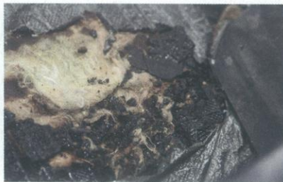
Gesundheitsgefahr: Wohnmobile und -wagen wurden vielfach mit Glaswolle gedämmt (l.). Raus damit: Ihre Fasern sind heute als krebserregend eingestuft. Die meisten Dämmstoffe zersetzen sich mit der Zeit. Der Verbund aus Folie, Bitumen und Naturfasern (M.) ebenso wie die Wolldämmung im Fahrzeugdach (r.)
