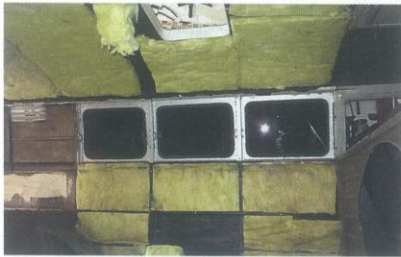
Gesundheitsgefahr: Wohnmobile und -wagen wurden vielfach mit Glaswolle gedämmt (l.). Raus damit: Ihre Fasern sind heute als krebserregend eingestuft. Die meisten Dämmstoffe zersetzen sich mit der Zeit. Der Verbund aus Folie, Bitumen und Naturfasern (M.) ebenso wie die Wolldämmung im Fahrzeugdach (r.)
