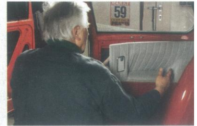
Trost: „Unpassende“ moderne Dämmungen verschwinden hinter den Verkleidungen
