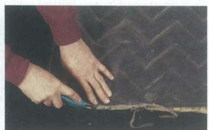
Auch aufwendige Konstruktionen lassen sich nachfertigen. In diesem Fall die bröselige Motorhauben-Dämmung eines Fiat 125, die mit Jutefilz und Innenhimmel-Kunstleder rekonstruiert wird. Für den Filz dient das Altteil als Schnittmuster (l.); mit dem Kunstleder wird er umnäht und originalgetreu abgesteppt
