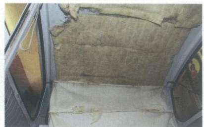
Gesundheitsgefahr: Wohnmobile und -wagen wurden vielfach mit Glaswolle gedämmt (l.). Raus damit: Ihre Fasern sind heute als krebserregend eingestuft. Die meisten Dämmstoffe zersetzen sich mit der Zeit. Der Verbund aus Folie, Bitumen und Naturfasern (M.) ebenso wie die Wolldämmung im Fahrzeugdach (r.)
