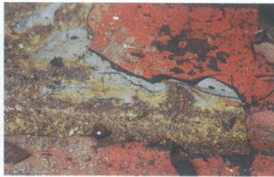
Bodendämmung geschieht in der Regel aus Temperaturgründen, der Fahrtwind kühlt das Bodenblech. Doch mit der Zeit wird die Isolierschicht oft zur Rostfalle: das Bitumen versprödet, Wasser dringt ein und sorgt für lange unentdeckte Korrosion (M.). Auch Schaumstoff (r.) altert und saugt Wasser wie ein Schwamm auf
