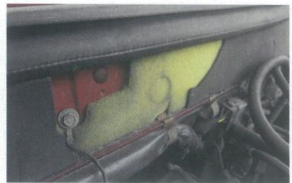
Bodendämmung geschieht in der Regel aus Temperaturgründen, der Fahrtwind kühlt das Bodenblech. Doch mit der Zeit wird die Isolierschicht oft zur Rostfalle: das Bitumen versprödet, Wasser dringt ein und sorgt für lange unentdeckte Korrosion (M.). Auch Schaumstoff (r.) altert und saugt Wasser wie ein Schwamm auf
